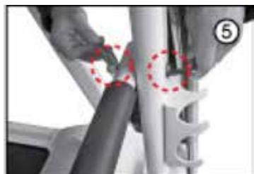
3: levante el brazo del panel de control y utilizar dos M8 \* 50 tornillos a través de apoyabrazos agujero para el tubo vertical, a continuación, atornillar bien (no presione las líneas de señal). A continuación, cubrir las guardias en el apoyabrazos apoyabrazos.
